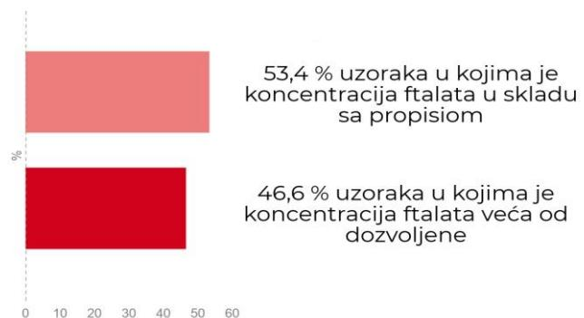
Slika 4. Laboratorijski rezultati testiranja uzoraka na sadržaj ftalata
